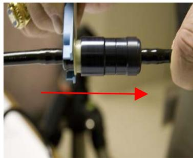
Inserte la herramienta alrededor de la terminación macho de la conexión rápida y aplique presión en la dirección de la flecha oprimiendo el anillo de liberación hacia el acoplamiento hembra.
